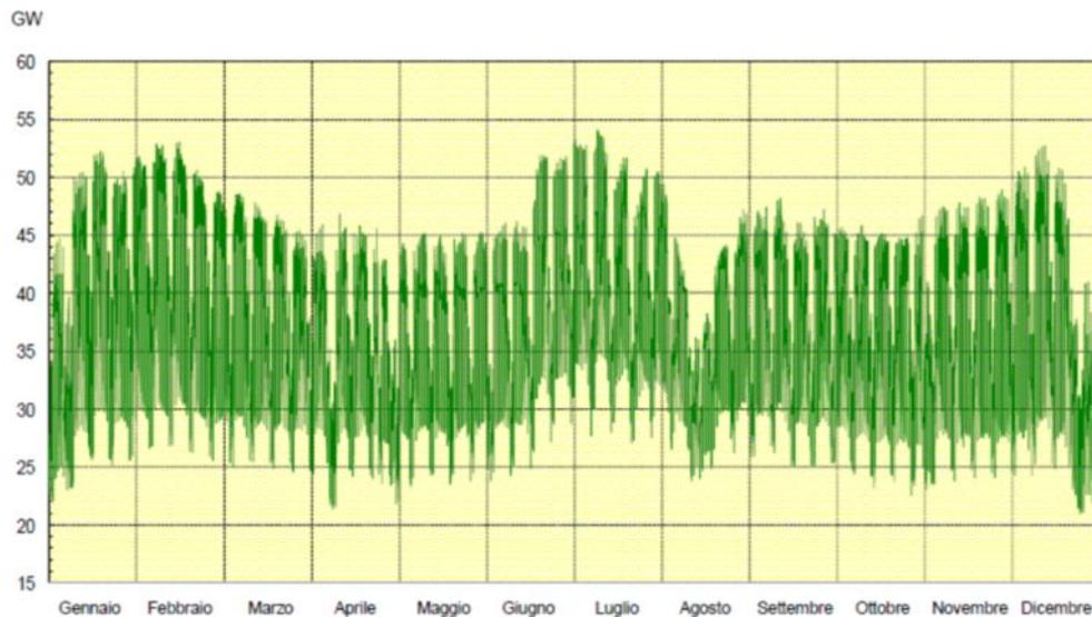
**Figura 18: Curva cronologica delle potenze orarie nel 2012 in Italia. (dati al netto dell'assorbimento per servizi ausiliari e per pompaggi).** (Rapporto mensile sul sistema elettrico, consuntivo dicembre 2012 - TERNA).
